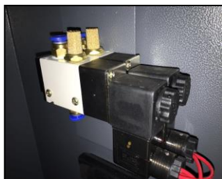
Рисунок 21 (электромагнитный воздушный клапан)
